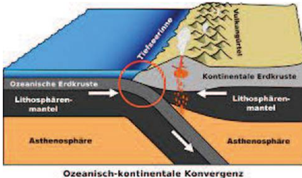
Abb. D.3.2. Prinzip einer Subduktionszone [Wikipedia, verändert].
